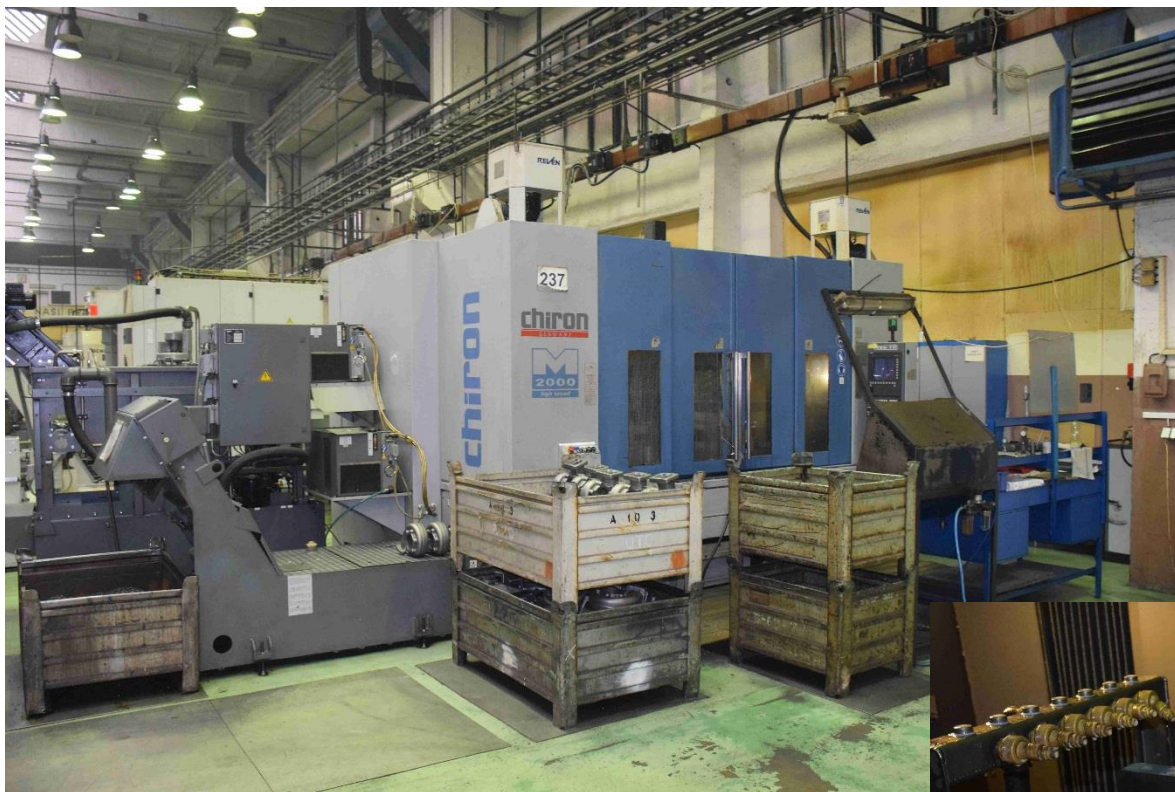
Chiron Mill 2000 – obrábění turbínové skříně
